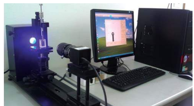
Hình 2. Thiết bị đo sức căng bề mặt phân chia dầu - nước
