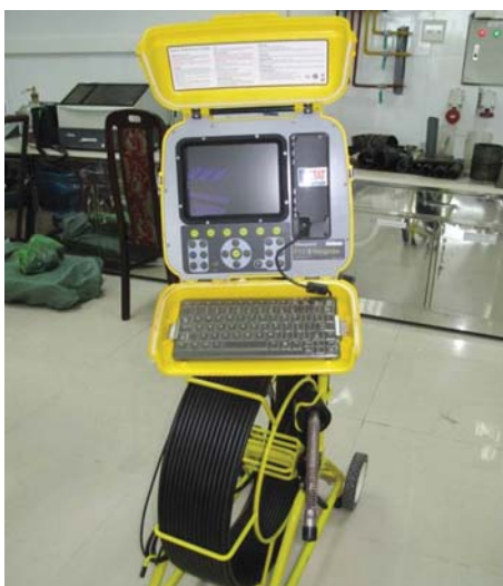
Hình 11. Hệ thống thiết bị nội soi hình ảnh SPX P340-Flexprobe
