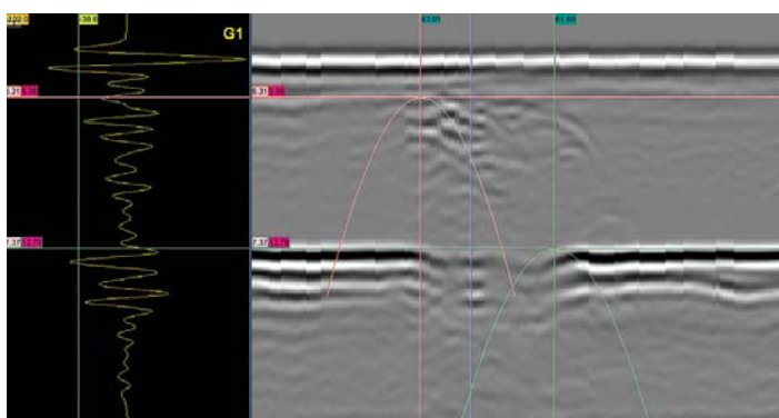
Hình 4. Hình ảnh khuyết tật xác định bằng phương pháp siêu âm nhiễu xạ
