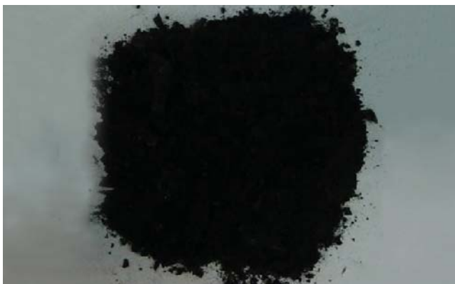
Hình 1. Than phụ phẩm thu được từ quá trình khí hóa viên nén sinh khối của Nhà máy Refgas [4]
