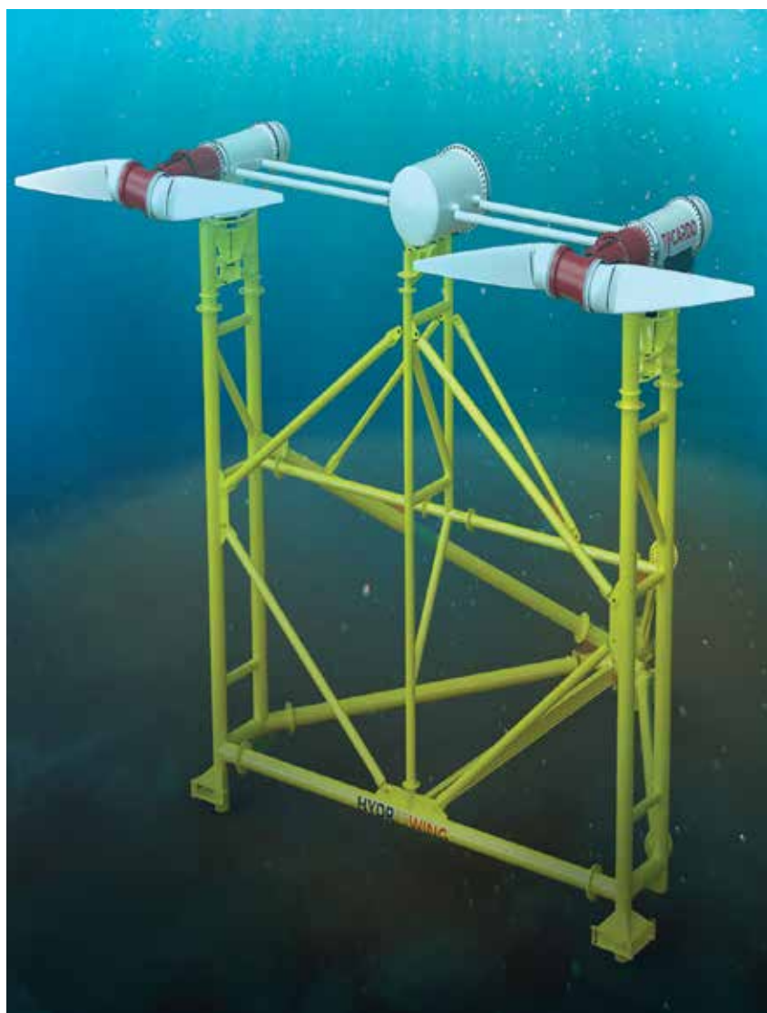
Hình 7. Chân đế và lắp đặt turbine năng lượng thủy triều công suất 1 - 1,5 MW tại dự án Morlais (Anglesey, 2024).
