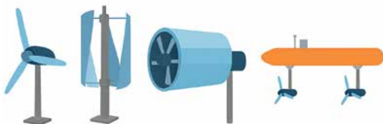
Hình 5. Các loại turbine thủy triều trục ngang (HAT), trục đứng (VAT), turbine có ống dẫn (ducted) và turbine nổi (floating) [12].
