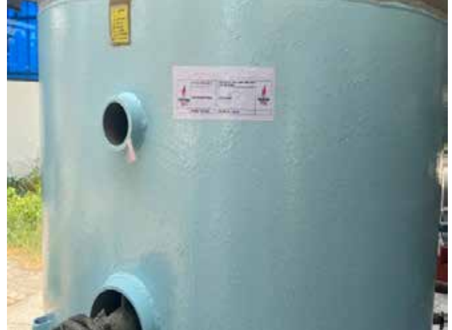
Hình 12. Kết quả thử nghiệm lớp phủ epoxy thông minh tại thiết bị Air Plan 40V8002 Nhà máy Đạm Phú Mỹ sau 2 tháng.
