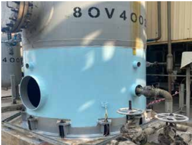
Hình 12. Kết quả thử nghiệm lớp phủ epoxy thông minh tại thiết bị Air Plan 40V8002 Nhà máy Đạm Phú Mỹ sau 2 tháng.
