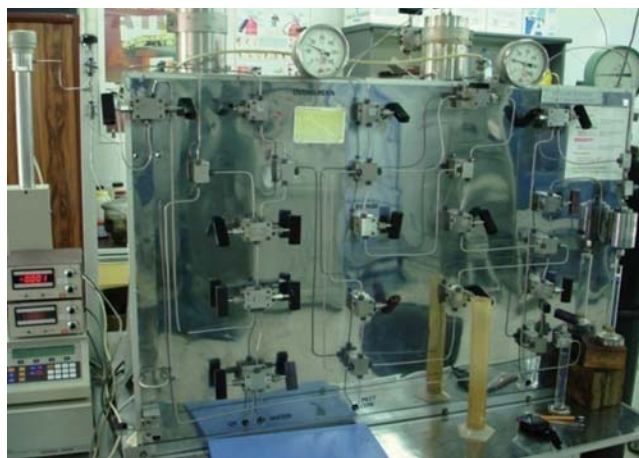
Hình 1. Thiết bị đánh giá khả năng phục hồi độ thấm của hệ vi nhũ tương trên mô hình dòng chảy đa pha
