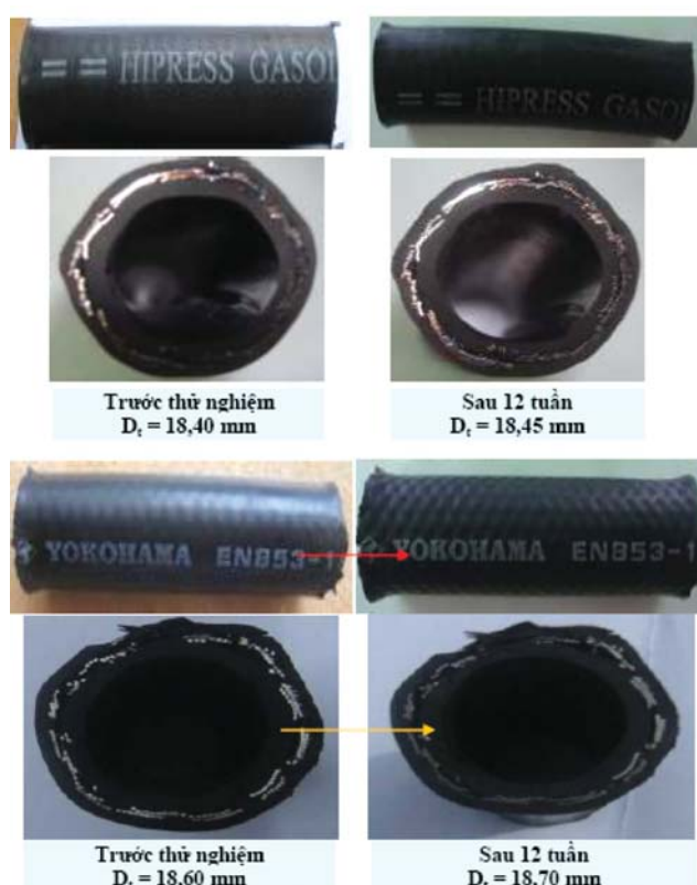
Hình 3. Thử nghiệm đánh giá tác động gây trương nở ống nối mềm Yokohama và Hipress của xăng pha n-butanol
