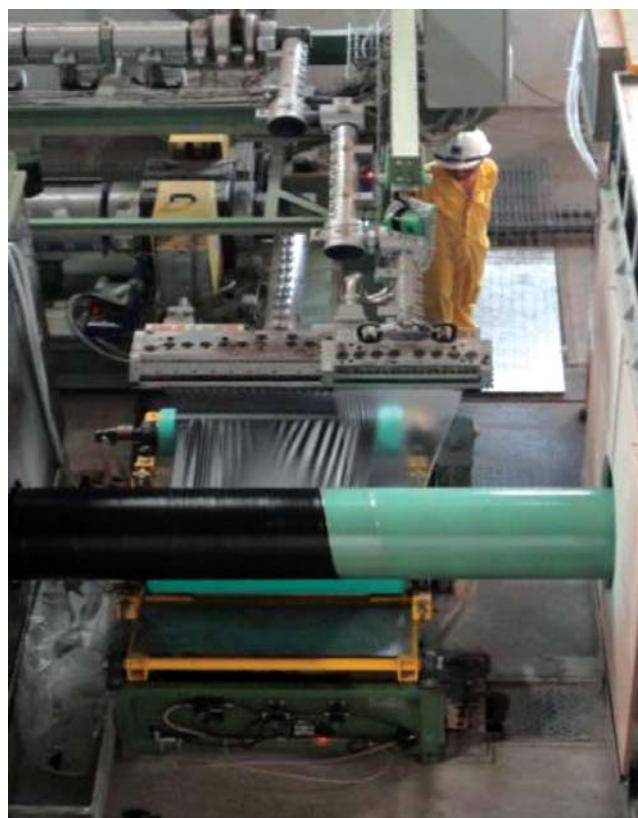
Hình 2. Dây chuyền công nghệ bọc chống ăn mòn tại Nhà máy Bọc ống Dầu khí
