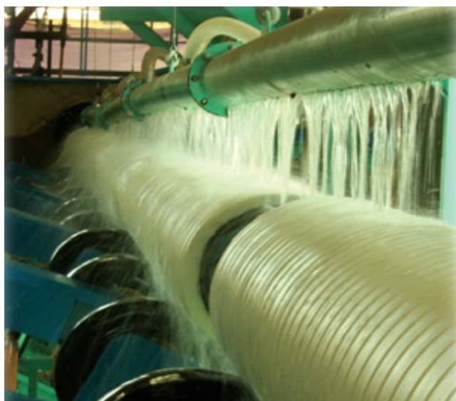
Ống sau khi bọc PP được chuyển qua khu vực làm mát
