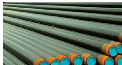
Sản phẩm bọc ống 3LPE - Dự án Hải Su Trắng/Hải Su Đen
