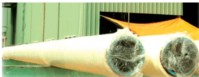
Ống chuẩn bị đưa vào dây chuyền bọc 5 lớp
